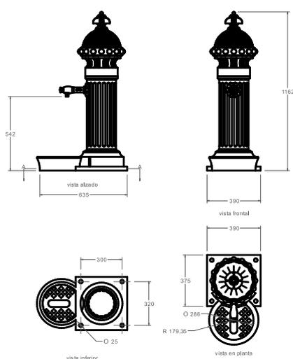
**MATERIAL:** Fundición gris tipo 20 con rejilla desagüe y grifo pulsador de latón cromado (plata), temporizado y con regulador de caudal.
