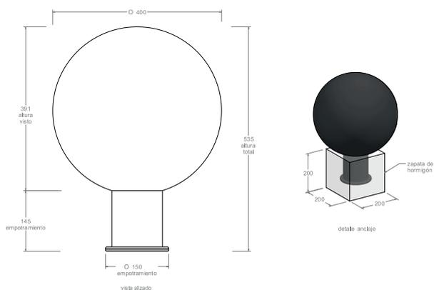
**MATERIAL:** Pilona en forma de bola en fundición gris tipo 20.
